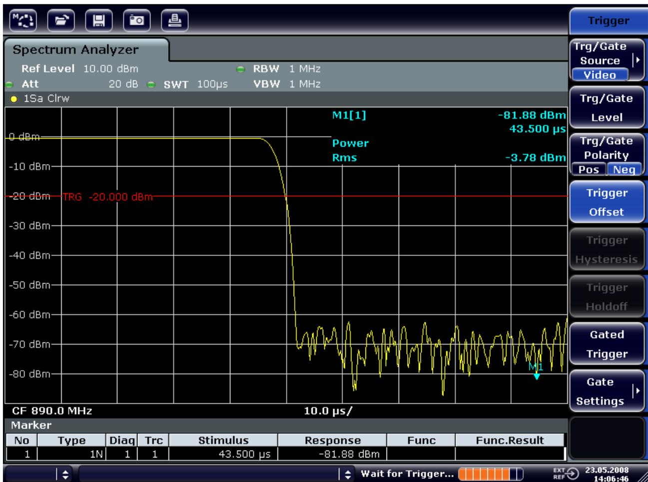
Figura 5-11: Flanco de bajada de la ráfaga GSM con alta resolución temporal
