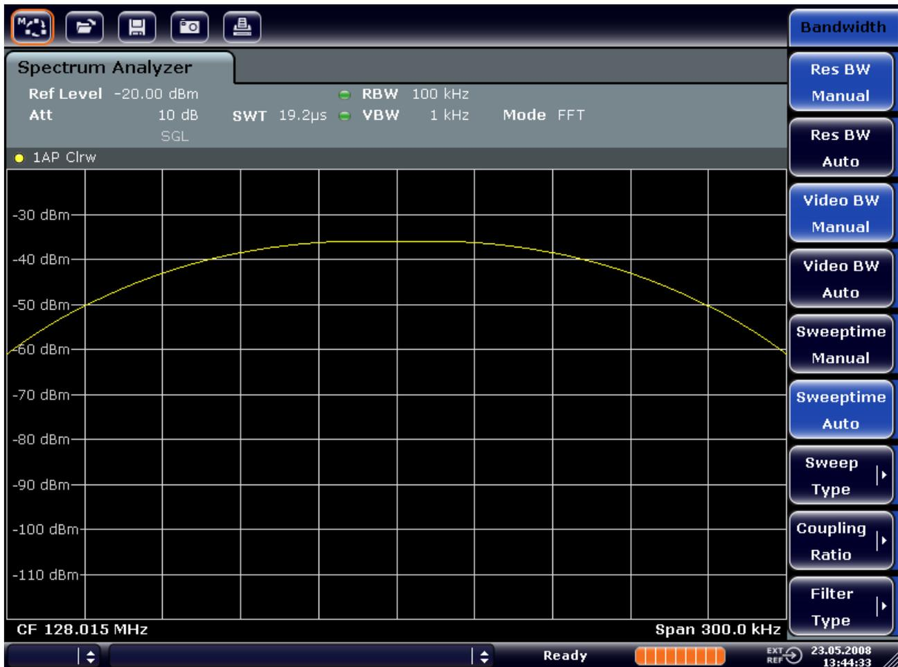
**Figura 5-5:** Medida de dos señales sinusoidales de RF del mismo nivel con el ancho de banda de resolución mayor a la separación en frecuencia entre ambas señales
